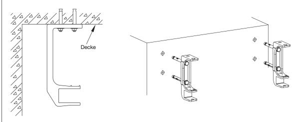
(Anmerkung: Die Mutter und die Unterlegscheiben können sich beim Transport voneinander lösen. In diesem Fall setzen Sie die Einzelteile der Verankerung, wie dargestellt, wieder zusammen.)
