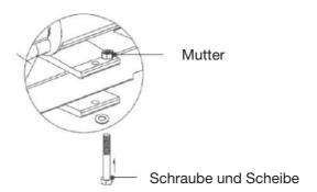
Sollte das Tragerohr nicht leicht in die Halterung hineinpassen, heben Sie die vordere Fallstange vorsichtig an, und richten Sie das Tragerohr richtig aus. Sollte dies dennoch nicht funktionieren, müssen die Schrauben an der Halterung gelöst werden, um die Halterung mit dem Tragerohr nochmals auszurichten. Ziehen Sie nun die Schrauben wieder an.
