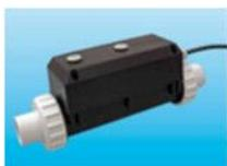
Der Thermostatdurchlauferhitzer ist bei allen elektronischen Hydra-Jet-Systemen möglich. Er sorgt für eine konstante Wassertemperatur. Die Heizdurchlauftemperatur ist werksseitig eingestellt. (Heizleistung 1 kW) Die Heizung ist nicht geeignet, das Badewasser aufzuheizen, sondern nur vorgesehen, um das Wasser auf einer konstanten Temperatur zu halten.
