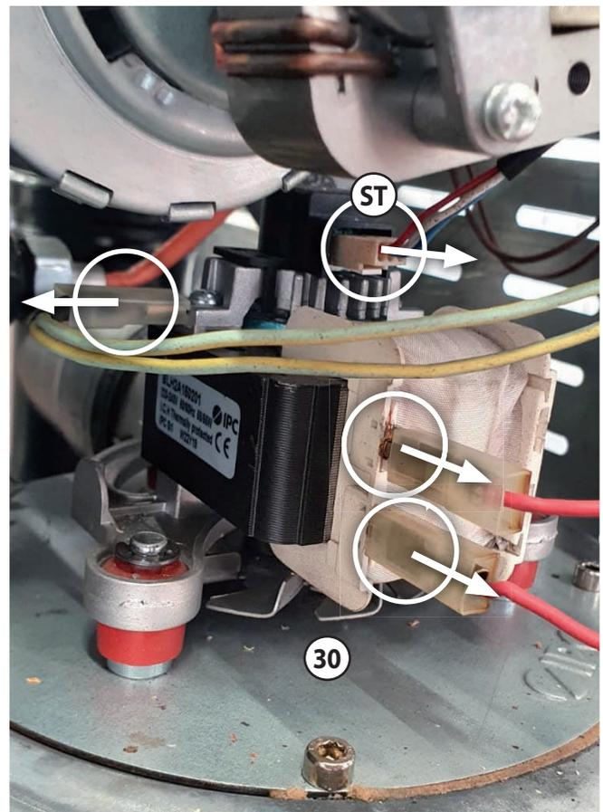
**i** Die Steckverbindung rechts oben im Bild (**ST**) kann nicht ohne Weiteres gelöst werden: Durch etwas Druck auf die Verriegelung an der Unterseite des Steckers wird die Steckverbindung entriegelt und der Stecker kann abgezogen werden.
