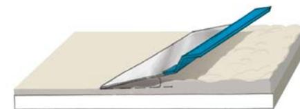
Die Knauf Flächenspachtel kann beidhändig flach angestellt werden. Eine Voraussetzung für optimal ebene Oberflächen, denn die Fläche wird zugezogen, aber kaum Material abgezogen.
