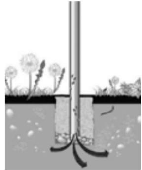
Nach dem Ausheben der Grube bedeckt man den Boden mit einer Schicht aus mittelgrobem Kies und stellt den Pfosten auf die Kiesschicht. Der anschließend eingefüllte erdfeuchte Beton verschließt somit nicht die untere Rohröffnung. Der Pfosten wird also nur von einem „Ring“ aus Beton umschlossen. Das Schwitzwasser kann ungehindert abfließen.
