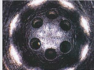
Komplett gereinigter Injektor bei Testbeginn.
