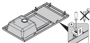
**FR** Ne pas serrer totalement les vis pour avoir une attache encore mobile.
