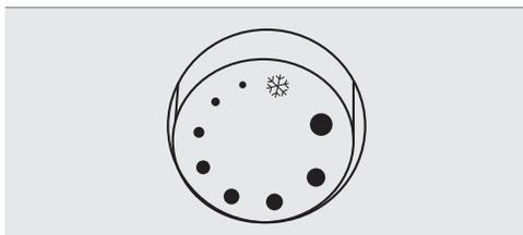
Abb.2: Temperaturregler (Thermostat)
