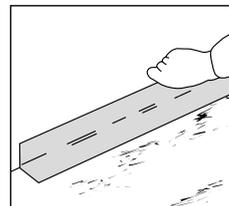
**6.** Dann *Knauf Flex-Dicht* vollflächig auf den Untergrund auftragen. Hierzu die Abdichtmasse mit einer 6 mm Zahnschachtel aufziehen und durchkämmen. Dies ergibt bei späterer Glättung eine Schichtdicke von ca. 2 mm.
