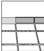
**20.** Dehn-, Eck- und Anschlussfugen müssen dauerelastisch mit Silicon verfugt werden. Hierbei ist eine Dreiflankenhaftung zu vermeiden. Das Silicon soll nur zwischen Wand (bzw. Sockelfliesen) und Bodenfliesen eine Verbindung eingehen. Bei tiefen Fugen kann ein DIN-Polyband eingebracht werden, um dies zu unterstützen.
