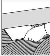
**12.** Schieben Sie die Fliesen in das Kleberbett ein. Legen Sie jede Fliese direkt an die jeweils benachbarte an und schieben Sie sie, bis die Fugenbreite gleichmäßig wird. Dadurch bleibt die Fuge frei von Klebemörtel. Bei fließfähiger Einstellung des Klebers erreichen Sie schon beim Einschieben vollsattete Benetzung.
