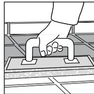
**20.** Bei hohen Außentemperaturen nach Fertigstellen der Fugarbeiten sollte die Fuge mehrmals leicht angefeuchtet werden.
