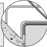
**13.** Kleberverschmutzungen auf den Fliesenoberseiten sofort entfernen und Kleberreste aus den Fugen kratzen. Nun den Kleber vollständig austrocknen lassen. Dies kann bis zu zwei oder drei Tagen dauern.
