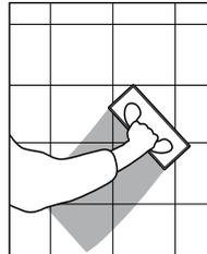
**18.** Bei Bruchplatten oder Fugenbreiten größer als 5 mm gibt es von Knauf eine besondere Lösung: das *Flex-Fugenbreit*. Dieses Material lässt sich einschlämmen oder in die Fuge gießen und füllt diese - weil selbstverlaufend - hohlraumfrei. Beim Gießen werden die Fliesenflächen kaum mit Fugenmörtel benetzt, dies erleichtert das Abreignen.
