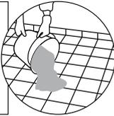
**17.** Bewegen Sie das Fugbrett immer diagonal zum Fugenverlauf. Damit erreichen Sie die optimale Fugenfüllung, wenn die Fugen nicht vollständig gefüllt sind, wiederholen Sie das Einschlämmen ca. 20 Min. nach dem ersten. Überschüssiges Material abziehen.
