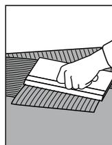
**7.** Dann die Stege mit einer Glättkelle oder Traufel glätten. Auf den meisten Untergründen kann *Flex-Dicht* in einem Arbeitsgang aufgetragen werden. Eine Schichtdicke von 2 mm ist zum Abdichten zwingend einzuhalten. Im Zweifel lieber einen 2. Auftrag vornehmen.
