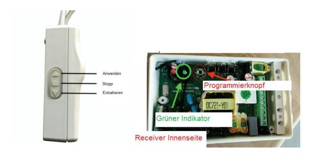
Sonne-/Wind-Sensor (DC116W) mit Receiver (DC721) verbinden:
