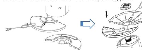
Nach dem Zusammenstecken der zwei Teile des Fußes, ziehen Sie die Sicherungsschraube fest, indem Sie sie im Uhrzeigersinn drehen.
