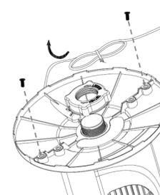
Ziehen Sie die beiden Schrauben wie im Bild links fest.
