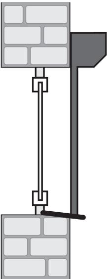
Die Befestigung erfolgt auf dem Mauerwerk. Die Gurtführung sitzt auf der Wand. Versichern Sie sich, dass genügend Platz für den Rollladenkasten und die Führungsschienen zur Verfügung steht.
