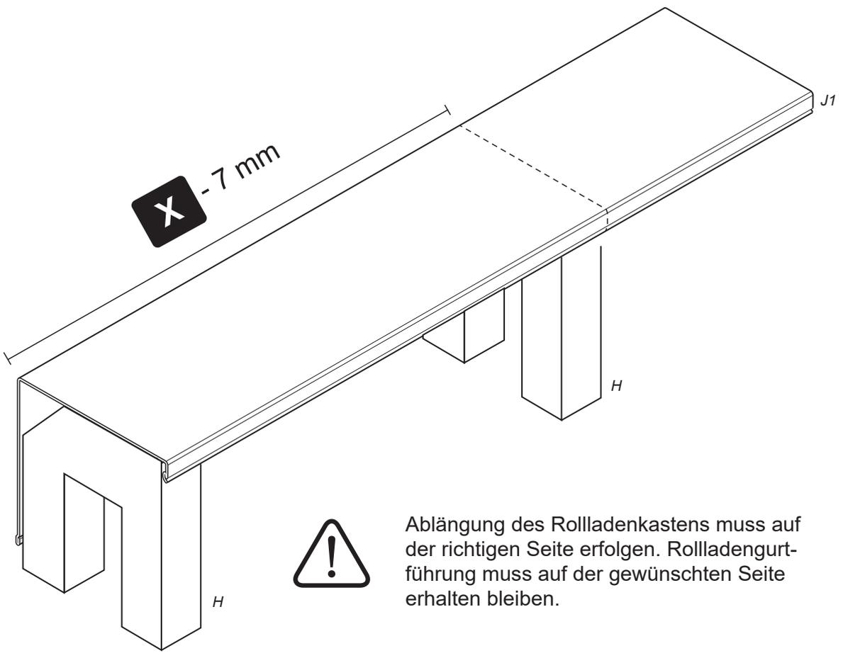
Ablängung des Rollladenkastens muss auf der richtigen Seite erfolgen. Rollladengurtführung muss auf der gewünschten Seite erhalten bleiben.
