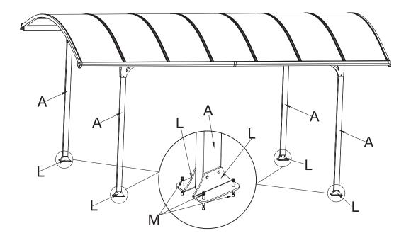
Stellen Sie den fertig montierten Carport auf die vorbereiteten Fundamente. Bohren Sie 16 Bohrlöcher mit einem Durchmesser von 6 mm und einer Tiefe von 60 mm. Fixieren Sie die Standfüße (L) mit den Bodenankern (M) an den Fundamenten.
