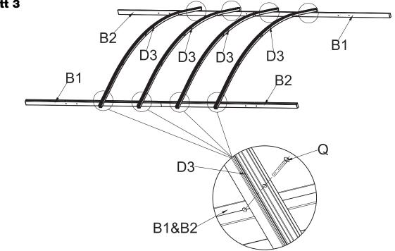
Legen Sie die mittleren Dachstreben (D3) auf die Balken (B1 + B2) und fixieren Sie die Verbindung mit den Schrauben (Q).
