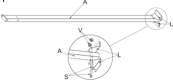
Setzen Sie die Standfüße (L) auf den Pfosten (A) und fixieren Sie die Verbindung mit den Schrauben (S) und Muttern (L).
