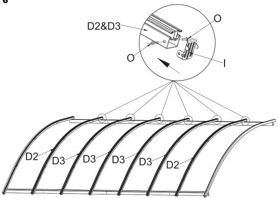
Setzen Sie die Abdeckkappen (I) auf die Dachstreben (D2 + D3) auf und fixieren Sie diese mit den Schrauben (O).
