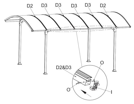
Setzen Sie die Abdeckkappen (I) auf die Dachstreben (D2 + D3) auf und fixieren Sie diese mit den Schrauben (O).
