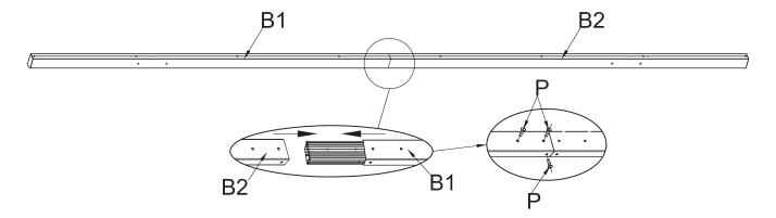
Verbinden Sie die beiden Balken (B1 + B2) miteinander und fixieren Sie die Verbindung mit den Schrauben (P).
