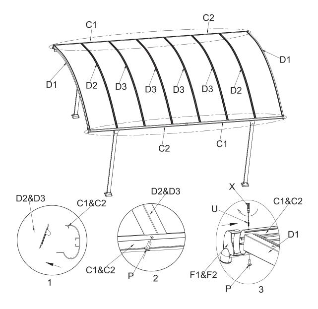
Bringen Sie die Regenrinnen-Konstruktion seitlich am Dach an und verschrauben Sie diese von unten mit den Dachstreben (D2 + D3). Danach setzen Sie an den Enden der Regenrinnen (C1 + C2) die Abdeckkappen (F1 + F2) an und fixieren diese mit den Schrauben (U) bzw. Schrauben (P).
