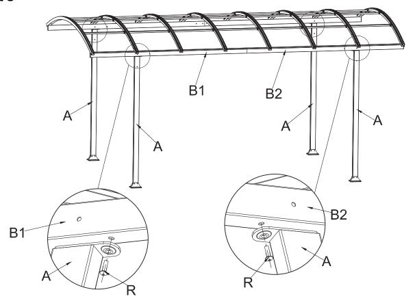
Setzen Sie die Balken (B1 + B2) des Dachrahmens auf die Pfosten (A) und fixieren Sie die Verbindung mit den Schrauben (R).
