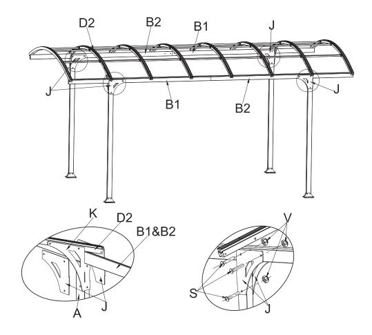
Bringen Sie die Winkelstücke (J) innen und außen zwischen den Pfosten (A) und den Balken (B1 + B2) an und fixieren Sie diese mit den Schrauben (S) und Muttern (V).
