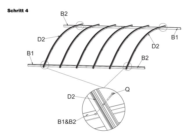
Legen Sie die Dachstreben (D2) auf die Balken (B1 + B2) und fixieren Sie die Verbindung mit den Schrauben (Q).
