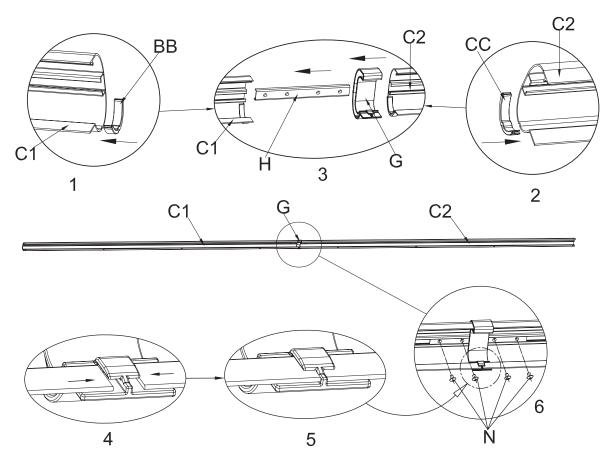
Setzen Sie die Abdeckungen (BB + CC) auf die Regenrinnen (C1 + C2) auf. Verbinden Sie die Regenrinnen (C1 + C2) mittels Verbindungsstück (G) und Schiene (H) und fixieren Sie die Verbindung mit den Schrauben (N).
