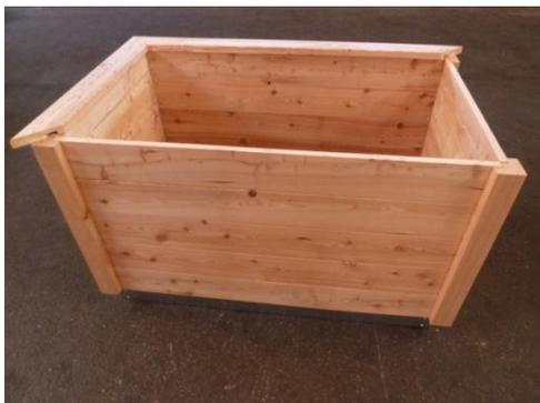
Nachdem Sie alle Seitenteile zusammengeschraubt haben, montieren Sie den Handlauf. Legen sie dazu die 4 Handlaufteile lose auf die Wand und richten Sie die Ecken ein.
