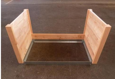
Stecken Sie die fertigen kurzen Seitenteile auf den Fundamentrahmen (Nut des Brettes auf Feder des Fundamentrahmens stecken!) und verschrauben Sie die längeren Wandbretter mit den Ecksäulen (wieder an beiden Enden je 2x vorbohren).
