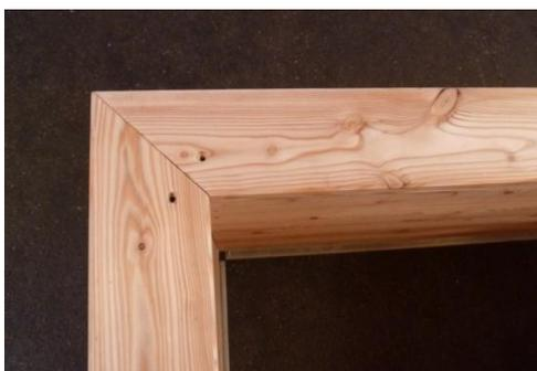
**ACHTUNG:** Öffnungen der Gehrung sind normal! Die Passung der Ecken wird sich durch Aufnahme und Abgabe von Feuchtigkeit ständig ändern. Bitte keine Fugenmasse (Silikon etc.) verwenden! Nun befestigen Sie den Handlauf an den vorgebohrten Stellen mit den beiliegenden Edelstahlschrauben 4,5x70mm.
