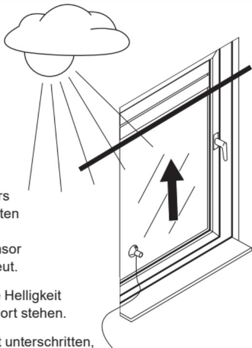
Wird die eingestellte Helligkeit ca. 10 Minuten ununterbrochen erkannt, fährt der Rollladen bis zum Saugknopf des Sonnensensors nach unten. Nach ca. 20 Minuten wird der Rollladen ein Stück hochgezogen, der Sonnensensor ist freigegeben und misst erneut.
