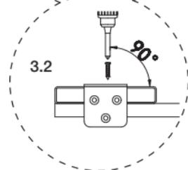
3.2 Achten Sie darauf, dass der Bohrer beim Vorbohren 90° senkrecht zum Alupfosten steht und ziehen Sie die Schrauben fest.
