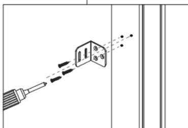
Es muss mit einem Bohrer (2,8 mm Durchmesser) vorgebohrt werden, bevor die Verbindungselemente befestigt werden können.
