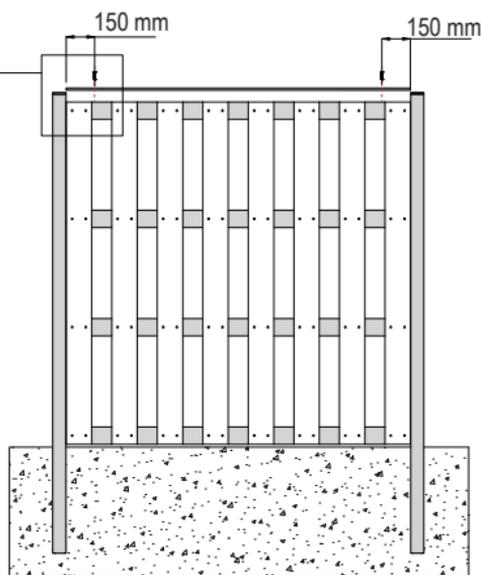
**Montage auf Beton/Zement
