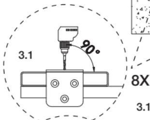
3.1 Muss vor dem Anschrauben vorgebohrt werden. Der Bohraufsatz sollte einen Durchmesser von 2 mm haben.
