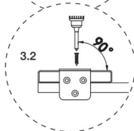
3.1 Muss vor dem Anschrauben vorgebohrt werden. Der Bohraufsatz sollte einen Durchmesser von 2 mm haben.
