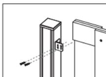
Der Zaun sollte 2 cm über dem Boden positioniert sein.
