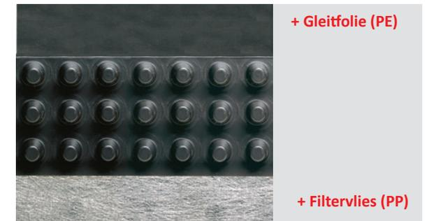
Die 3-schichtige Noppenbahn ist ein Muss bei allen Abdichtungen, die mit Dickbeschichtung ausgeführt sind. Die PE-Folie bietet Schutz für die pastöse Abdichtung (keine punktuelle Belastung). Durch das Vlies wird ein Zuschlammern verhindert.
