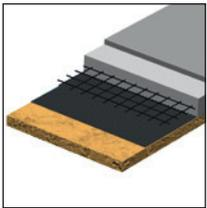
Als Trennschicht Unterbau auf dem Erdreich ausrollen mit den Noppen nach unten. Bahnen-Überlappung mindestens 20 cm. Armierung mit Distanzstücken direkt auf die FONDALINE 400 auflegen.
