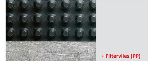
FONDALINE GEO 500 ist eine mit einem Spezialvlies versehene Noppenbahn, die eine vollflächige Drainage gewährleistet. Durch das Vlies wird ein Zuschlammern verhindert. FONDALINE GEO 500 kommt bei allen Abdichtungen zum Einsatz, die keine Probleme durch punktuelle Belastungen aufweisen (z.B. Dichtungsbahn, Bitumenanstrich oder Dichtschlämme). Besondere Vorteile bietet die Bahn bei stärkerem Wasseranfall an Hanglagen und wasserundurchlässigen Böden.
