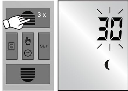
Der gewünschte Zeitversatz der automatischen Abfahrzeit kann in 10-Minuten Schritten eingestellt werden.
