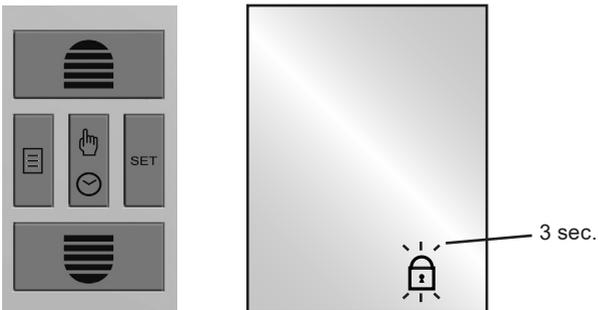
Die Tastensperre ist nun aktiv. Der Rollladen kann manuell betätigt werden. Unbefugte können keine Änderungen an den Einstellungen vornehmen.
