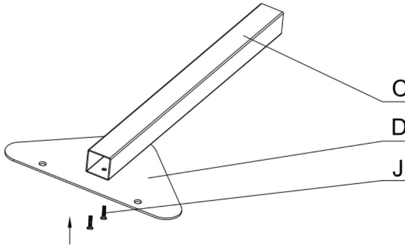
Verbinde die Bodenplatte mit der Sockelstrebe.
