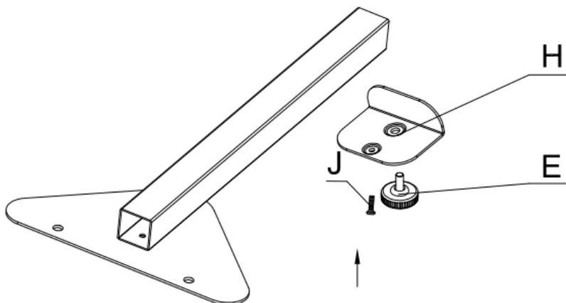
Drehe die Fußkappen in die Endstücke und befestige diese an den Sockelstreben.
