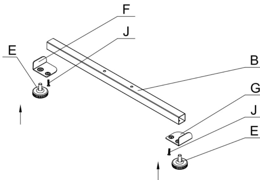
Drehe die Fußkappen in die Endstücke und befestige diese an den Sockelstreben.
