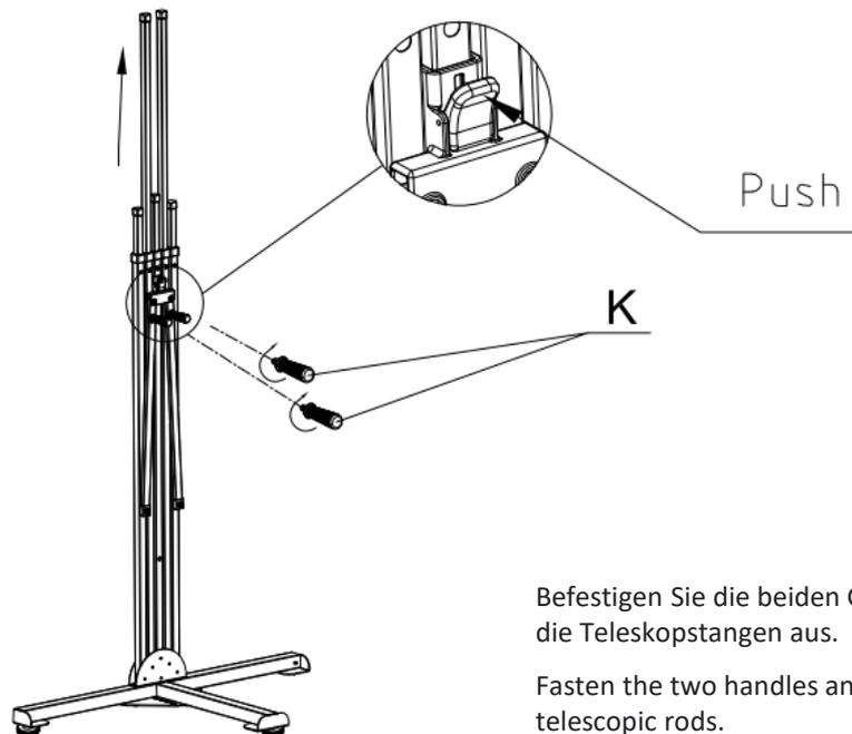
Befestigen Sie die beiden Griffe und ziehen Sie die Teleskopstangen aus.
