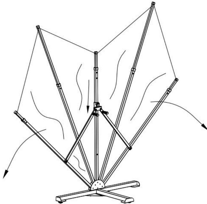
Zum Öffnen, löse den Knopf und falte den Sichtschutz auseinander indem du die Griffe nach unten führst.
