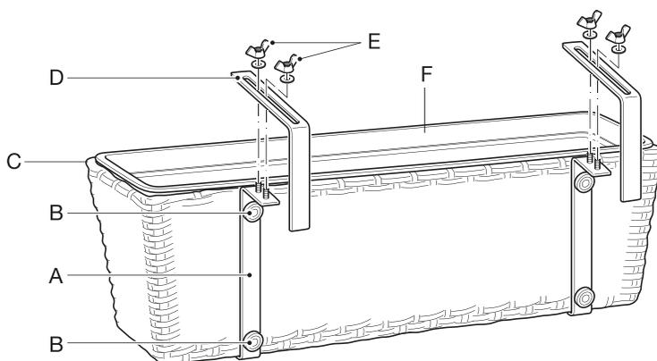
1. Tragebügel A mit den Schrauben B am Produktkörper C befestigen.
