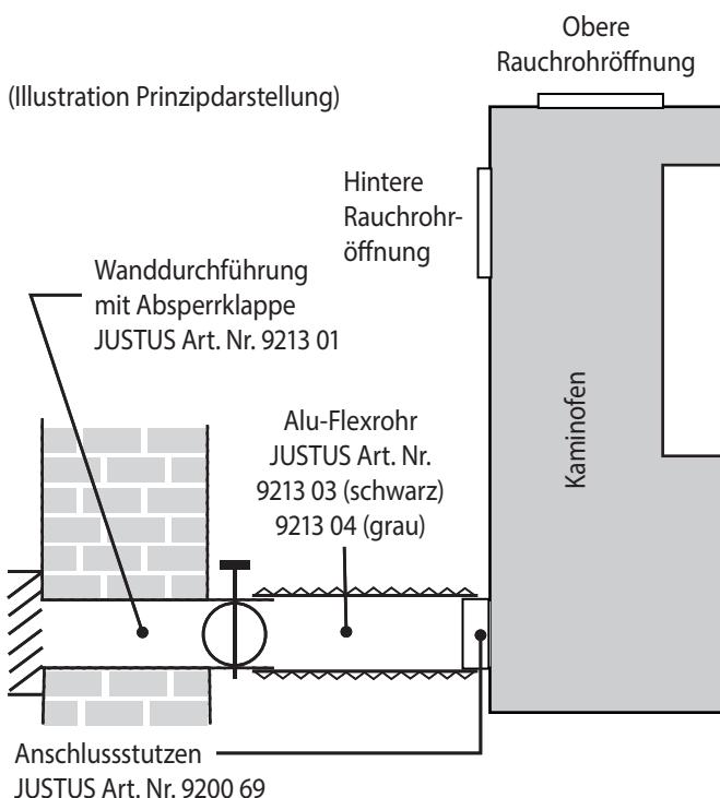
► Achten Sie bei einer externen Verbrennungsluftversorgung auf dichte Rohrführung!
