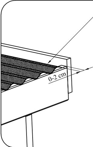
DE: Die Platten müssen mit der rauen Oberfläche nach oben montiert werden (Aufkleber nach oben).
