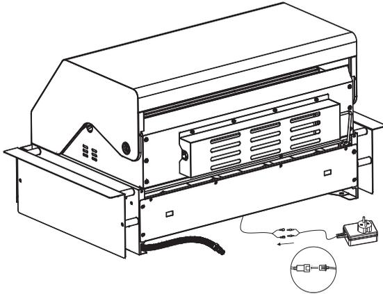
Den Transformator an einer wettergeschützten Stelle befestigen, die möglichst weit von den heissen Bereichen des Grills entfernt ist.
