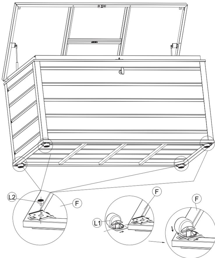
Entfernen Sie L2 bei der Montage und folgen Sie den Schritten, wie in der Abbildung zu L1 dargestellt.
