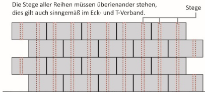
Prinzipskizze Wandverband Ansicht
