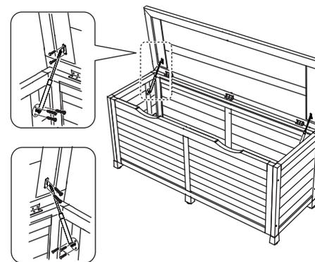
**5** Befestigen Sie die Dämpfer im rechten- und linken Wandelement und mit dem Deckelement, verwenden Sie hierzu Schrauben aus Set D
