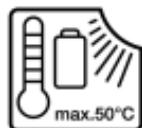
**Beskyt akkuen mod varme (f.eks. også mod varige solstråler, brand, snavs, vand og fugtighed).** Der er risiko for ekspllosion og kortslutning.
