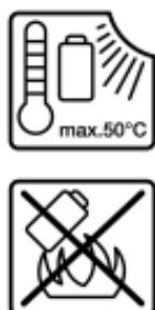
**Conservez la batterie à l'abri de la chaleur, en la protégeant p. ex. de l'ensoleillement direct, du feu, de la saleté, de l'eau et de l'humidité.** Il existe un risque d'explosion et de courts-circuits.
