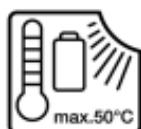
**Zaštitite aku-bateriju od vrućine, npr. također od stalnog sunčevog zračenja, vatre, prljavštine, vode i vlage.** Postoji opasnost od eksplozije i kratkog spoja.
