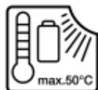
**Beskytt batteriet mot varme, f.eks. også mot langvarig sollys og ild, skitt, vann og fuktighet.** Det er fare for eksplosjon og kortslutning.
