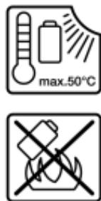
**Захищайте акумуляторну батарею від тепла, зокрема, напр., від сонячних променів, вогню, бруду води та вологи.** Існує небезпека вибуху і короткого замикання.
