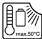
**Zaštitite akumulator od izvora topline, npr. i od trajnog sunčevog zračenja, vatre, prljavštine, vode i vlage.** Postoji opasnost od eksplozije i kratkog spoja.
