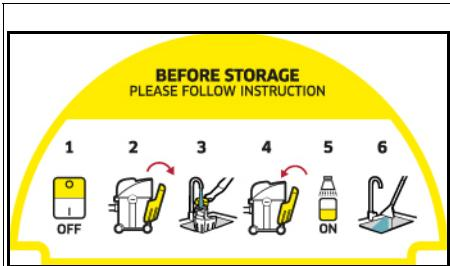
Na odkládací ploše přístroje je nálepka, která popisuje, jak přístroj před uložením vyčistit:
