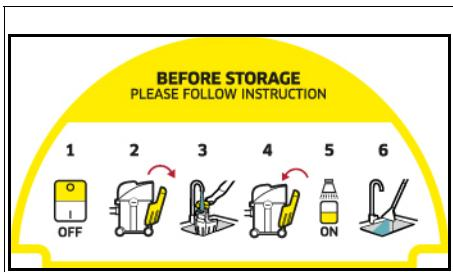
Auf der Ablagefläche des Geräts befindet sich ein Aufkleber, der die Geräteneinigung vor der Geräteaufbewahrung beschreibt:
