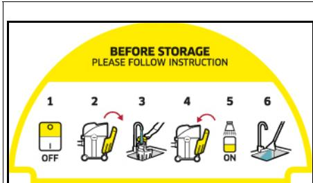
Na base de apoio do aparelho, encontra-se um autocollante que descreve como deve limpar o aparelho antes de guardar:
