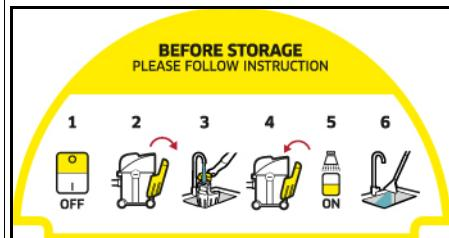
Cihazın saklama rafında, cihazın saklanmadan önce nasıl temizleneceğini açıklayan bir etiket bulunmaktadır:
