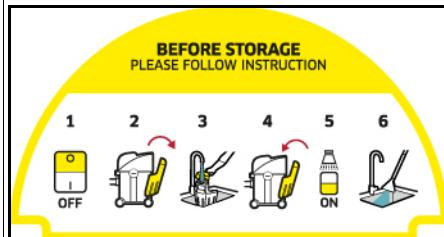
Na odkladacej ploche prístroja je nalepka, ktorá opisuje čistenie prístroja pred jeho uložením:
