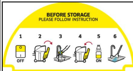
På apparatets opbevaringsoverflade er der en mærkat, der beskriver rengøringen af apparatet, før det opbevares:
