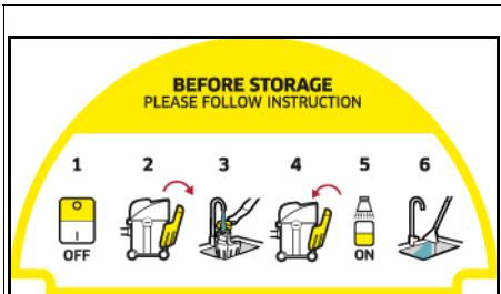
Na powierzchni do przechowywania urządzenia znajduje się naklejka, opisująca sposób czyszczenia urządzenia przed jego przechowywaniem:
