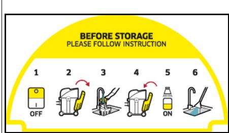
На полке устройства имеется наклейка, на которой описано, как очистить устройство перед хранением:
