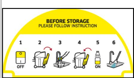
Sur la tablette de l'appareil se trouve un autocollant qui décrit le nettoyage de l'appareil avant de le ranger :
