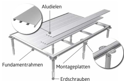
**Montagedauer:** 2 – 4 Stunden zu zweit (je nach handwerklichem Geschick und Produkt). **Benötigtes Werkzeug:** Schlagbohrmaschine, Bohrer Ø 40 x 570 mm, Wasserwaage, Bohrmaschine, Gabelschlüssel SW13 und SW24, Schaufel.
