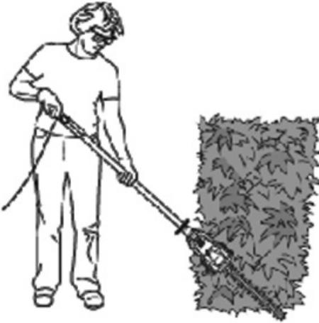
Halten Sie die Teleskopheckenschere wie abgebildet, wenn Sie das Gerät zum Schneiden von niedrigen Pflanzen oder Bodendeckern verwenden.
