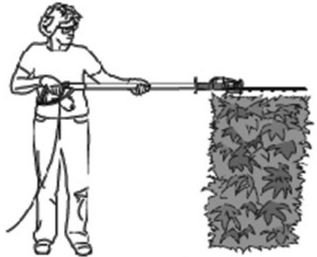
Halten Sie die Teleskopheckenschere wie abgebildet, wenn Sie das Gerät zum Schneiden von Unterseiten und Seiten von Hecken oder Sträuchern verwenden.
