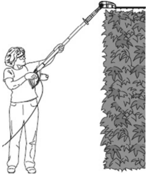
Halten Sie die Teleskopheckenschere wie abgebildet, wenn Sie das Gerät zum Schneiden von kleineren Hecken oder Sträuchern verwenden.
