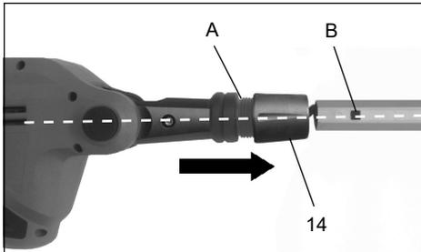
2. Drehen Sie die Schraubhülse 14 im Uhrzeigersinn (↻) fest, um den Messerkopf endgültig am Rohr zu befestigen.
