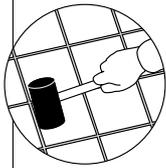
**3.** In Feuchträumen und bei feuchtigkeitsempfindlichen Untergründen muss sichergestellt sein, dass unter dem alten Fliesenbelag eine Abdichtung vorliegt. Ggf. ist diese nach dem Grundieren mit *Knauf Flex-Dicht* über dem alten Fliesenbelag aufzutragen. Alte Installationsanschlüsse wenn nötig vorher verlängern und die Abdichtung daran anschließen.
