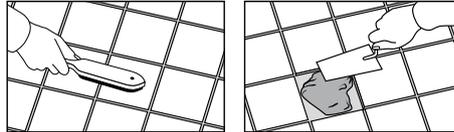
**2.** Mit der Klopfprobe prüfen, ob die Fliesen fest sitzen. Lose Fliesen entfernen, die Lücke mit *Knauf Reparaturspachtel* verschließen.
