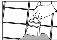
**8.** *Knauf Spezialhaftgrund* mit Rolle oder Maurerquast gleichmäßig auftragen, Pfützenbildung vermeiden.
