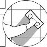
**19.** Sobald der Fugenmörtel in den Fugen matt antrocknet, mit leicht angefeuchtetem Schwamm oder Schwamm-brett reinigen. Niemals zu viel Wasser verwenden!
