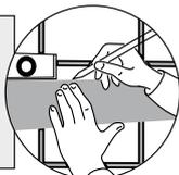
**TIPP** **Wand verfliesen:** Benutzen Sie eine Richtschnur, diese wird an den beiden äußeren Fliesen an den Ecken angelegt und entlang der gezeichneten Linie angesetzt.
