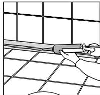
**21.** Es ist zu beachten, dass eine Dreiflankenhaftung vermieden wird, das Silicon soll nur zwischen Wand (bzw. Sockelfliesen) und Bodenfliesen eine Verbindung eingehen. Bei tiefen Fugen kann hierzu ein DIN-Polyband eingebracht werden, um dies zu unterstützen. Vor der Hautbildung die frische Siliconfuge mit einem Wasser-Spülmittel-Gemisch und einem Fugenglätter glatt streichen.
