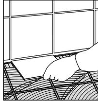
**TIPP** **Boden verfliesen:** In rechteckigen Räumen spannen Sie über dem Boden und parallel zu den längsten Seitenwänden eine Richtschnur. An dieser richten Sie die erste Fliesenreihe aus. Die nächste Fliesenreihe verlegen Sie parallel dazu.
