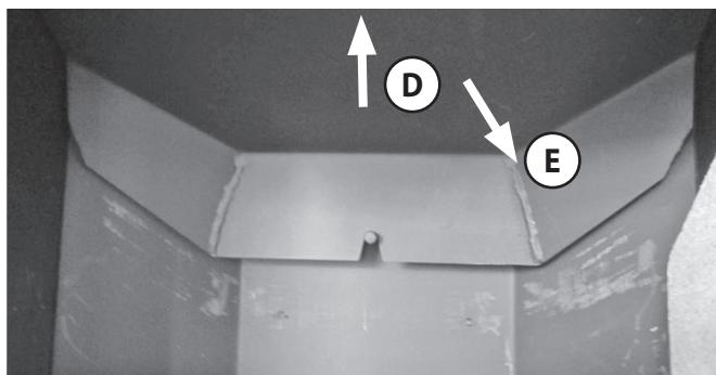
Darüber ist eine dritte Rauchgasumlenkung aus Blech angeordnet.
