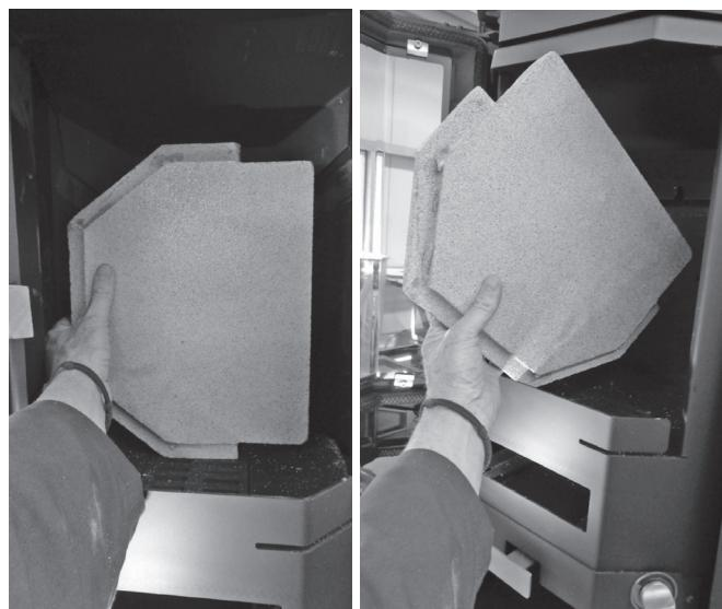
Über der Vermiculite-Rauchgasumlenkung sitzt eine zweite Rauchgasumlenkung aus Blech.
