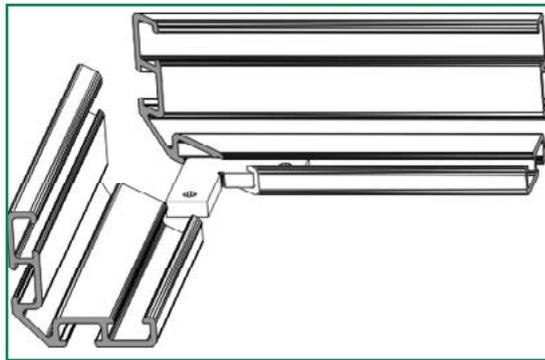
Die Winkel mit Madenschrauben (V13) werden zur Verbindung der Borteneckwinkel benötigt.
