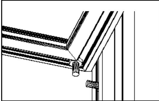
In den nach innen liegenden Schraubkanal der Design-Sprosse werden drei Schrauben M6 x 12 eingeschoben.
