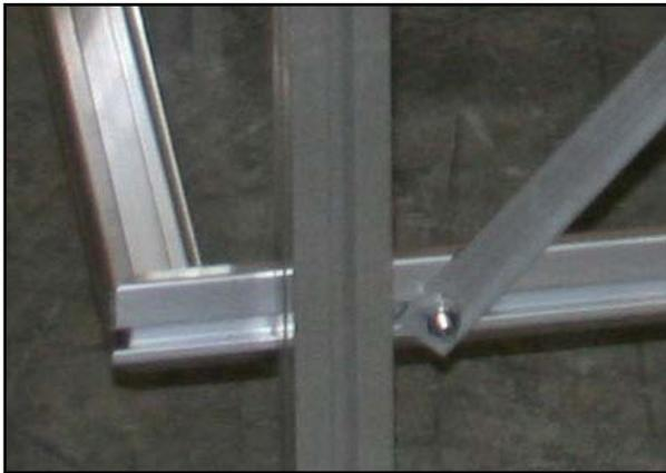
Im unteren Bereich schieben Sie die Schraube so, dass Sie die Querstrebe aufstecken können. Fixieren Sie diese nun mit Mutter M6.
