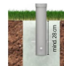
Variante 2: Steher zum Einbetonieren, höhenverstellbar bis zu 25 cm
