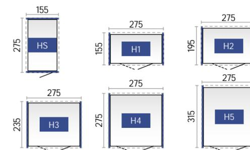
TIPP: Sie können das HighLine® ab Gr. H2 ganz nach Ihren Bedürfnissen drehen und die Standardtür kann in jeder Seitenwand eingebaut werden. Ab Gr. H4 ist auch ein seitlicher Einbau der Doppeltür möglich.
