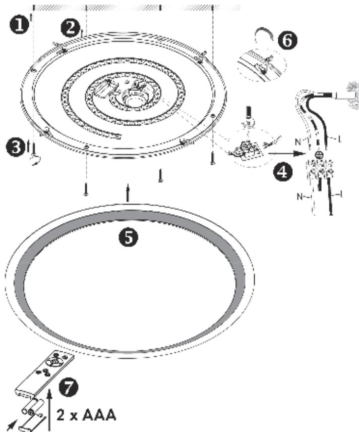
**Wichtig:** Der elektrische Anschluss muss durch eine Elektrofachkraft erfolgen. Diese muss Kenntnis über die Eigenschaften der Leuchte und Anschlussbestimmungen haben.
