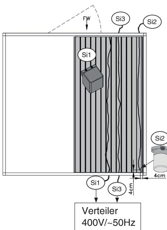
Die Verlegung der Elektroleitung zum Anschluss an das Versorgungsnetz (nicht im Lieferumfang enthalten) darf nicht innerhalb der Saunawände erfolgen.
