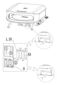
SCHRITT 2: Stellen Sie nach dem Einlegen der Batterien sicher, dass sich der Bedienknopf in der Position "OFF" befindet, drücken Sie den Starter, um das LED-Licht einzuschalten, das LED-Licht zeigt weiße Farbe, drehen Sie den Bedienknopf gegen den Uhrzeigersinn, das LED-Licht wechselt zu rot. Denken Sie daran, den Starter erneut zu drücken, um das LED-Licht nach Gebrauch auszuschalten.
