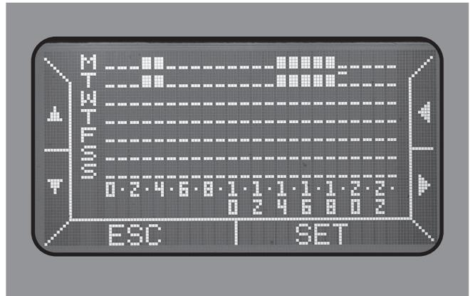
Abb. 9b: Display-Anzeige SET TIMER, programmiert
