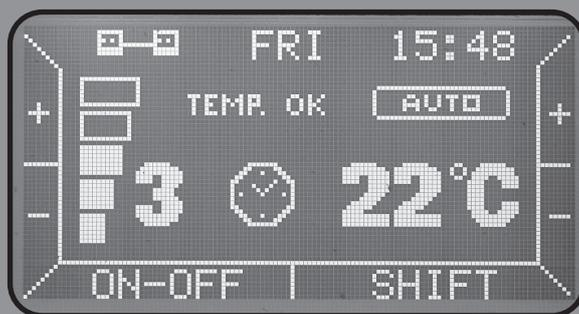
Abb. 11: Display-Anzeige bei Automatikbetrieb
