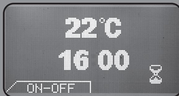
Abb. 7: Display-Anzeige während der Abkühlphase
