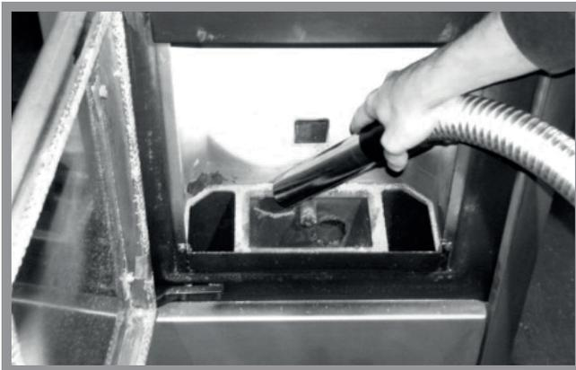
Abb. 12d: Reinigung der Topfhalterung
