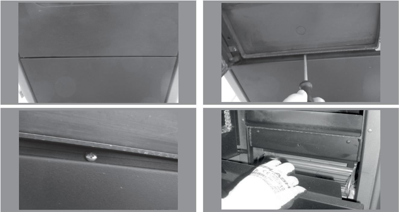
Abb. 13a: Öffnen der Frontplatte
