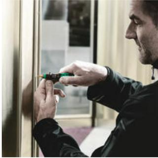
Besonders bei Verschraubungen in empfindliche Materialien oder hochwertige Oberflächen ermöglichen Bits mit Diamantbeschichtung ein sicheres, schnelleres und kostengünstigeres Arbeiten. Die Werkzeuge haben eine hohe Lebensdauer.
