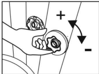
**Wichtig:** Ist die Durchflussgeschwindigkeit des HydroJet™-Massagesystems auf „niedrig“ eingestellt, reicht der Wasserdurchfluss nicht aus, um das Licht zu aktivieren. Genießen Sie das Licht bei maximalem Wasserdurchfluss.
