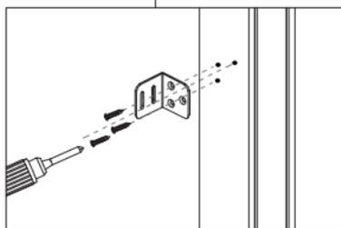
Es muss mit einem Bohrer ( $\varnothing$  2,8 mm) vorgebohrt werden, bevor die Verbindungselemente befestigt werden können.
