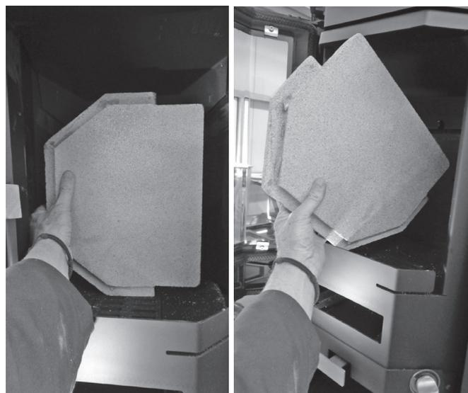
Über der Vermiculite-Heizgasumlenkung sitzt eine zweite Rauchgasumlenkung aus Blech.
