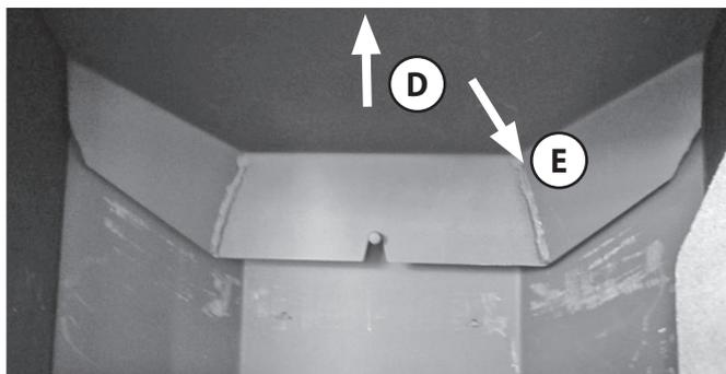
Darüber ist eine dritte Heizgasumlenkung aus Blech angeordnet.
