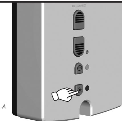
Durch Drücken der Taste Sonne wird die Sonnenfunktion ein- oder ausgeschaltet:
