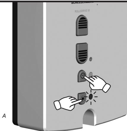
**Funktion:** Die Sonnenautomatik wird bei der Übernahme des Helligkeitswertes eingeschaltet. Drücken Sie gleichzeitig die Taste Sonne und die Taste Uhr.
