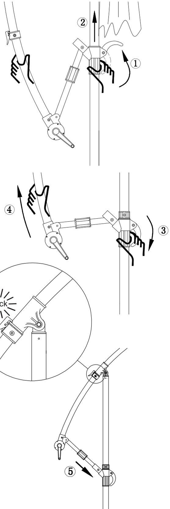
Durch Drehen der Kurbel im Uhrzeigersinn öffnet sich der Schirm.
