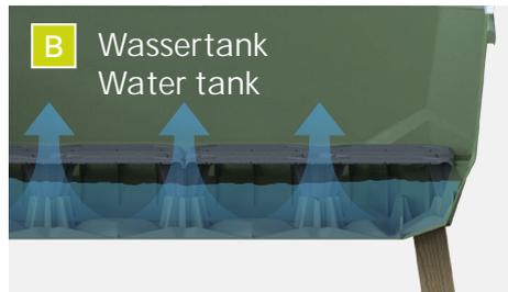
Die Zwischenböden bilden den Wassertank mit 15 Liter Wasserkapazität. Dadurch werden die Pflanzen konstant mit Wasser versorgt und gleichzeitig wird Staunässe vermieden.
