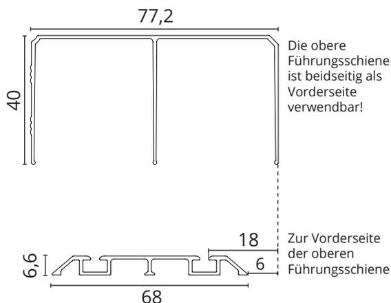
Die obere Führungsschiene ist beidseitig als Vorderseite verwendbar!
