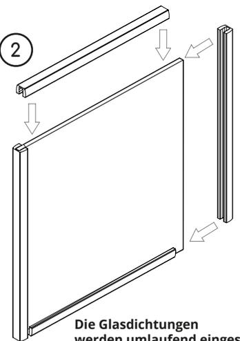
Die Glasdichtungen werden umlaufend eingesetzt.
