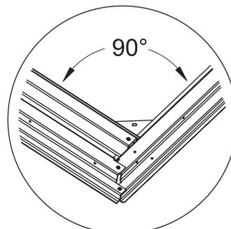
Messen Sie den Rahmen nach der Montage rundherum sorgfältig aus, um eine gleichmäßige Ausrichtung sicherzustellen.
