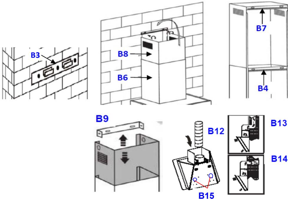
12. Montage und Endverlegung des Abluftschlauches **B12** gemäss **B13** oder **B14** vornehmen.
