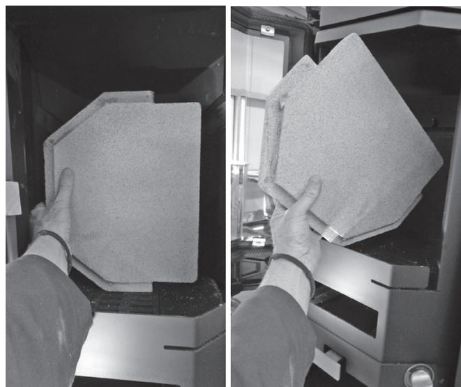
Über der Vermiculite-Heizgasumlenkung sitzt eine zweite Rauchgasumlenkung aus Blech.
