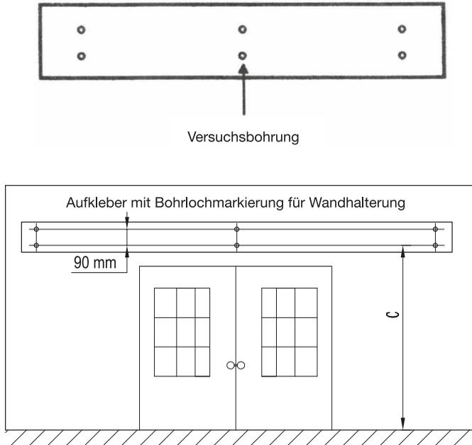
Achtung! Achten Sie bei niedriger Montage darauf, dass sich keine Gegenstände im Ausfahrbereich befinden.
