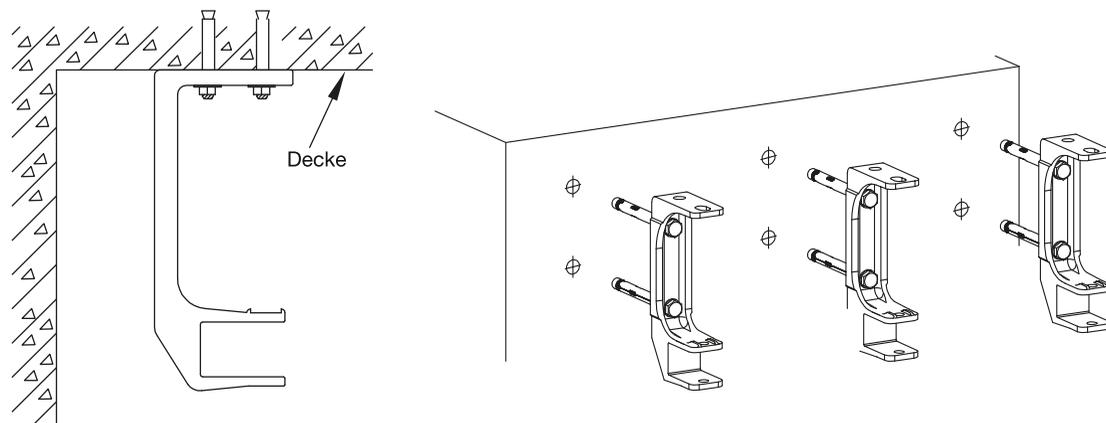
**(Anmerkung:** Die Muttern und die Unterlegscheiben können sich beim Transport voneinander lösen. In diesem Fall setzen Sie die Einzelteile der Verankerung, wie dargestellt, wieder zusammen.)
