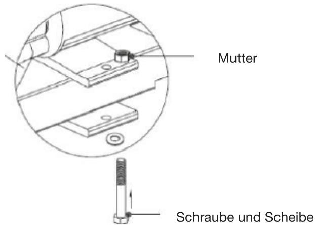
Sollte das Tragerohr nicht leicht in die Halterung hineinpassen, heben Sie die vordere Fallstange vorsichtig an, und richten Sie das Tragerohr richtig aus. Sollte dies dennoch nicht funktionieren, müssen die Schrauben an der Halterung gelöst werden, um die Halterung mit dem Tragerohr nochmals auszurichten. Ziehen Sie nun die Schrauben wieder an.
